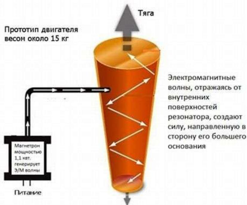
Фиг. 2. Схема работы движителя EmDrive
