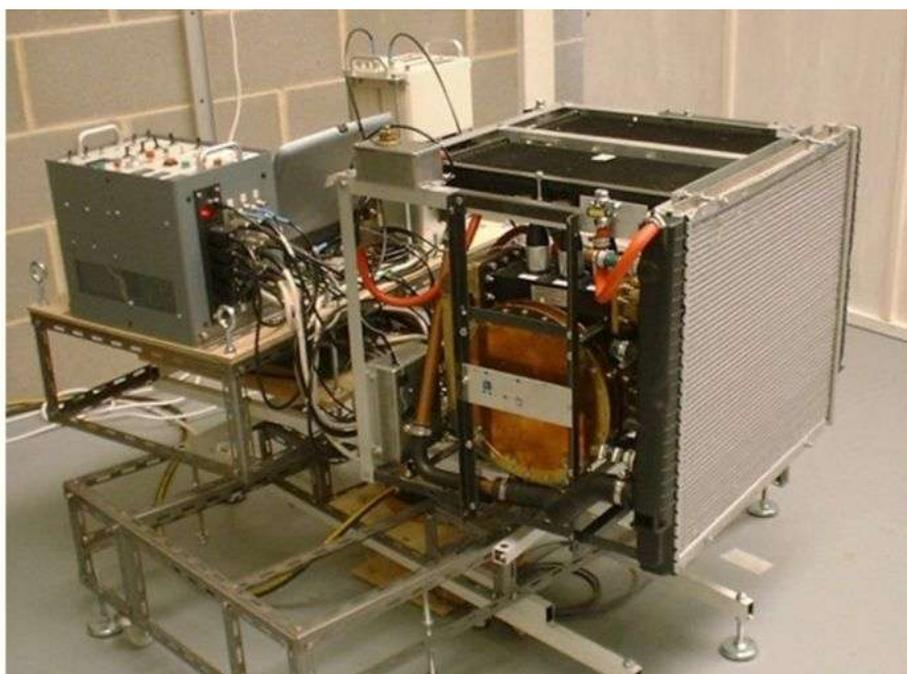
Фиг. 4. Демонстрационный образец EmDrive, который был испытан в США, он развивает тягу 96 миллиньютонов при входной мощности 334 ватт.
