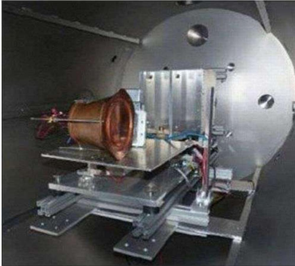
Фиг.3. Испытания демонстрационного образца EmDrive в вакуумной камере.
